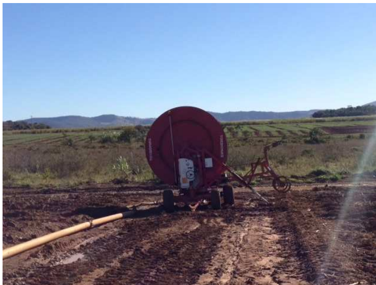
Figura 3. Carretel Turbomaq modelo 140/GSV/350-4RII utilizado no experimento.
